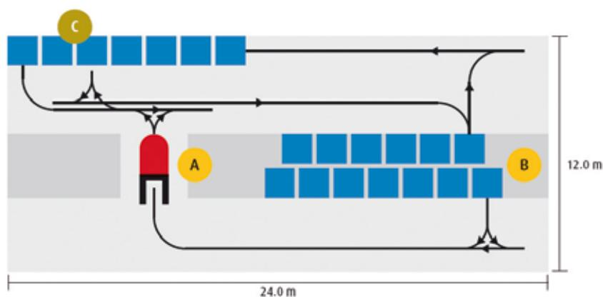
La produttività dei carrelli Linde è certificata TUV. Il test eseguito consiste nello scarico di 14 casse da un rimorchio e loro stoccaggio in 2 file a distanza prestabilita. Il minor tempo impiegato dal carrello Linde dimostra la sua miglior manovrabilità e facilità di azionamento.
